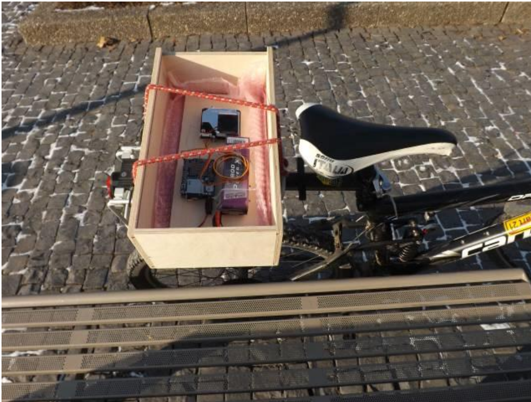
Abb. 3: Die Kiste auf dem Gepäckträger mit dem Feinstaubmessgerät, gepolstert in „kalifornischer Luft“
