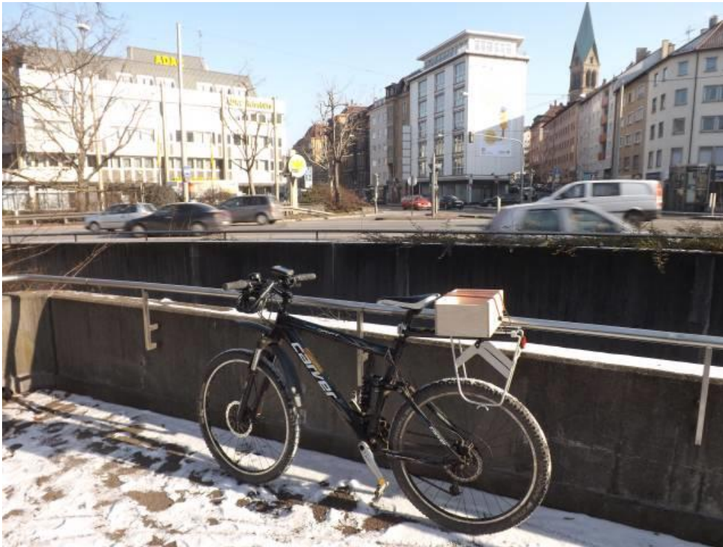
Abb. 1: Das mit der mobilen-Feinstaub Messanlage ausgestattete Fahrrad
