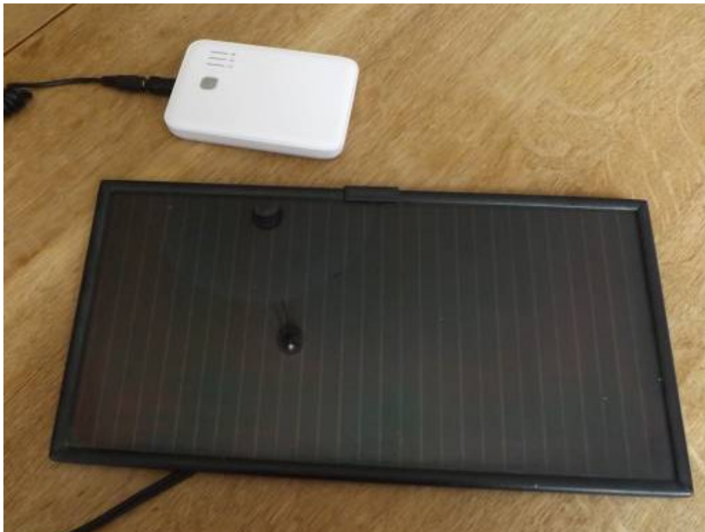
Abb. 4: 2Watt Solarpanel zum Laden der USB Power Bank, die normalerweise als Notstromversorgung von Smartphones gedacht ist
