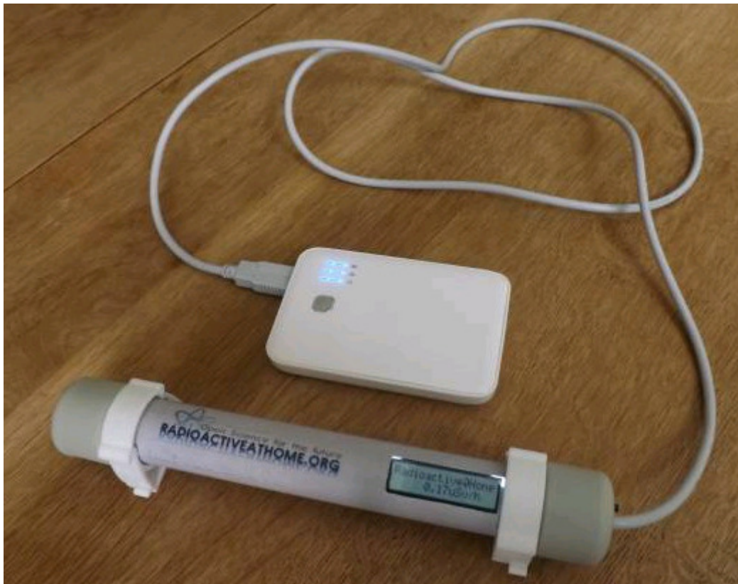
Abb. 1: Geigerzähler aus dem Internet mit USB Stromversorgung und Anzeige der Gamma-Ortsdosisleistung in \mu\text{Sv/h} zusätzlich zur akustischen Knack-Anzeige (für 30Euro)
