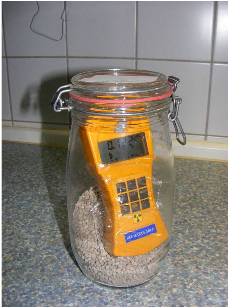
Abb. 11: Radon-Exhalation aus Düngemittel, gemessen in einem Einmachglas mit einem herkömmlichen Alpha-empfindlichen Geigerzähler
