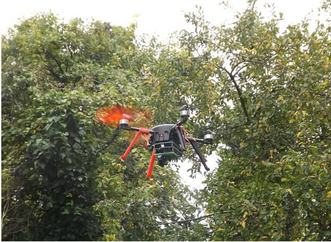
Abb. 4: RC Eye One Extreme mit dem Radioaktivitäts-Messgerät im Schwebestand
