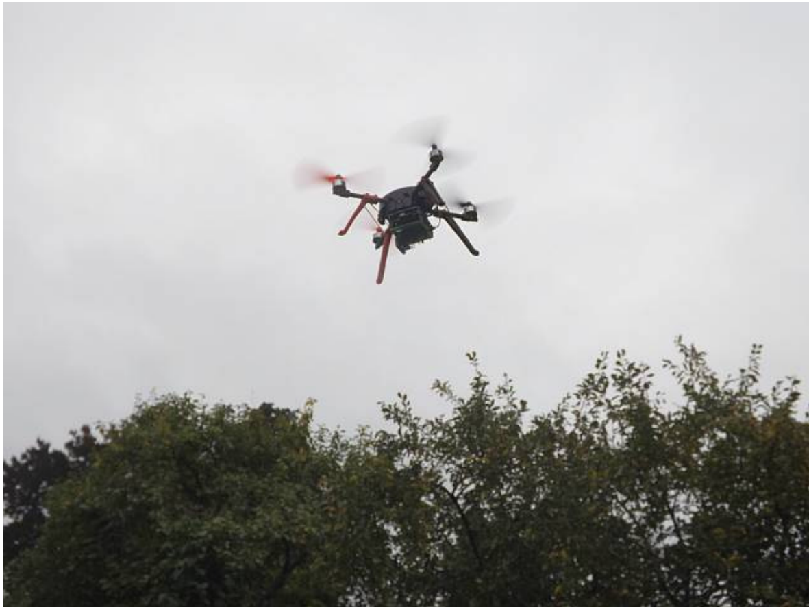
Abb. 5: Auch der „Hover“ Flug geht problemlos trotz der Last des Strahlungs-Messgeräts
