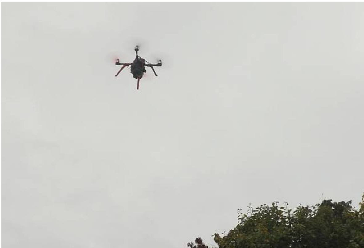
Abb. 6: Nur zu hoch sollte man nicht fliegen, sonst kann man nicht mehr erkennen was vorne (rote Rotoren) und hinten (schwarze Rotoren) ist. Diese Info braucht man, um noch richtig steuern zu können.
