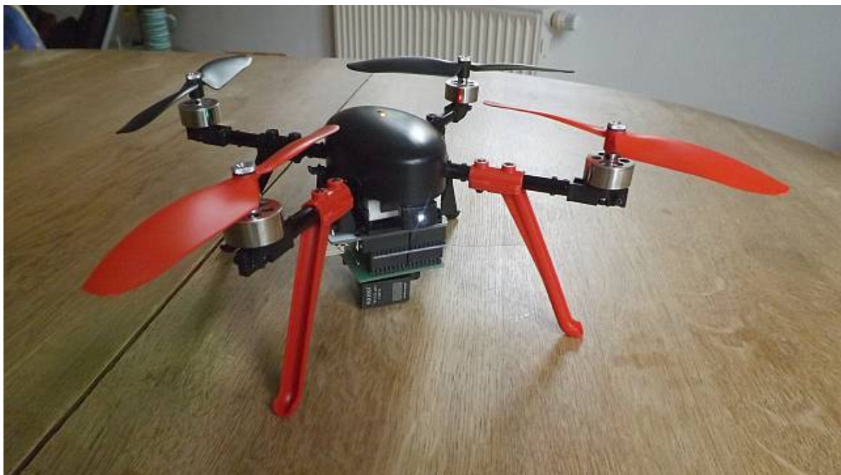
Abb. 1: Der Low Cost Multikopter „RC Eye One Xtreme“ von RCLogger mit aufgesetztem Arduino, SD-Karten Shield und Teviso-Shield
