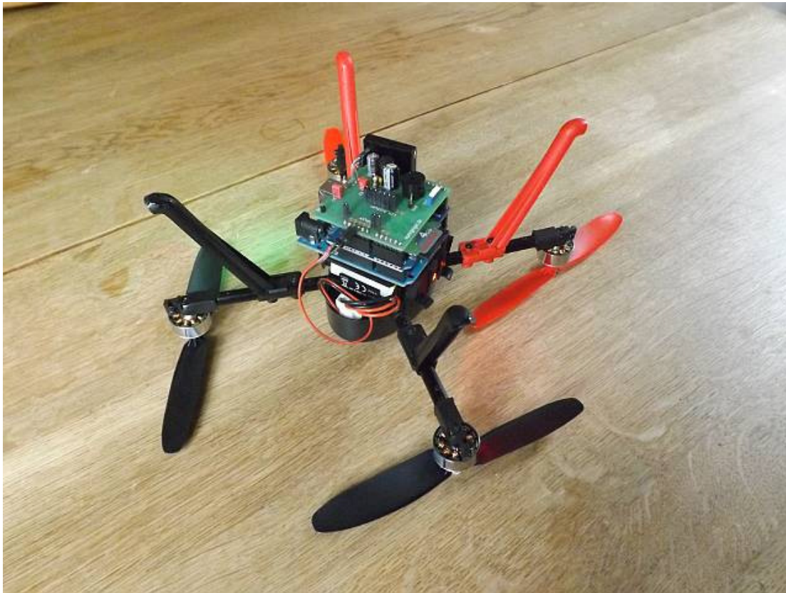
Abb. 2: Der Multikopter mit Arduino und den Shields von der Unterseite. Zur Stromversorgung kann ein intern bereitgestellter 5V Anschluss benutzt werden.
