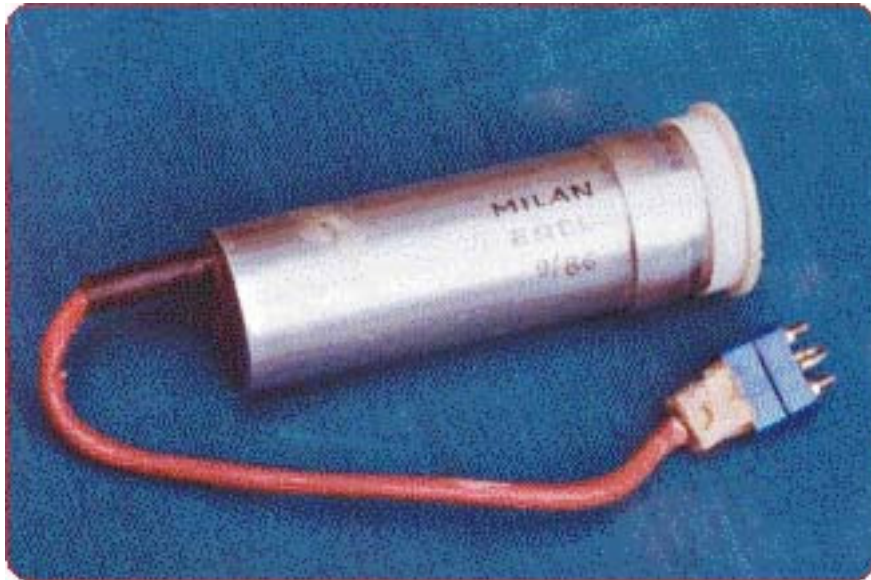
Abb. 5: MILAN „Tracking-Flare“ Kapsel mit radioaktivem Thorium zur Strahlungsverstärkung im Infraroten Bereich
