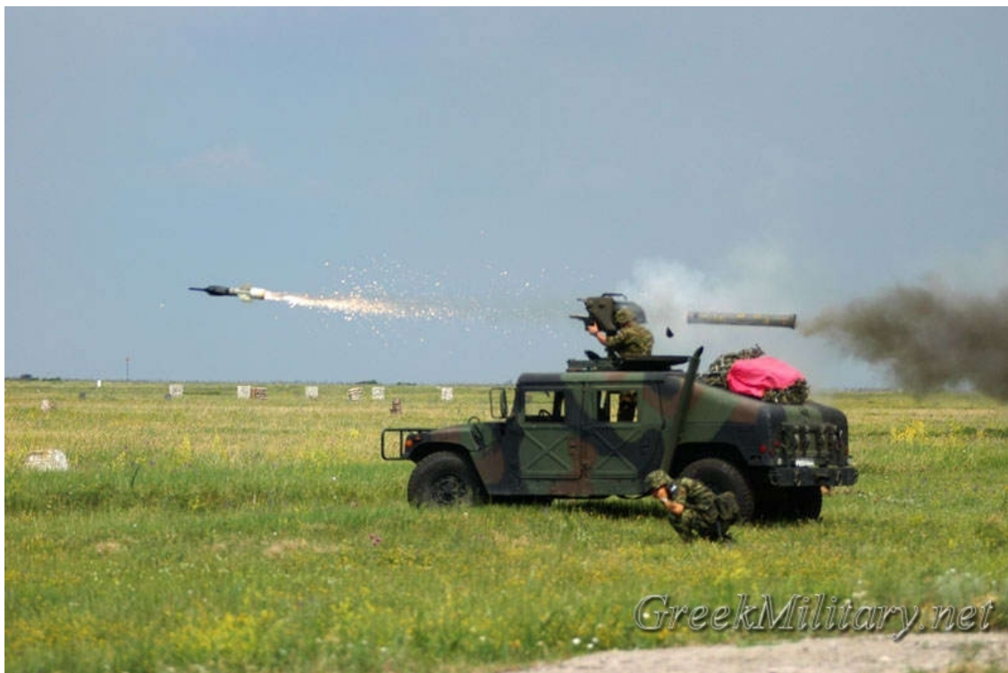
Abb. 7: Auf einem Übungsgelände abgefeuerte MILAN-Rakete, das Thorium im infrarot-intensiven Leuchtschweif wird in die Umgebung versprüht
