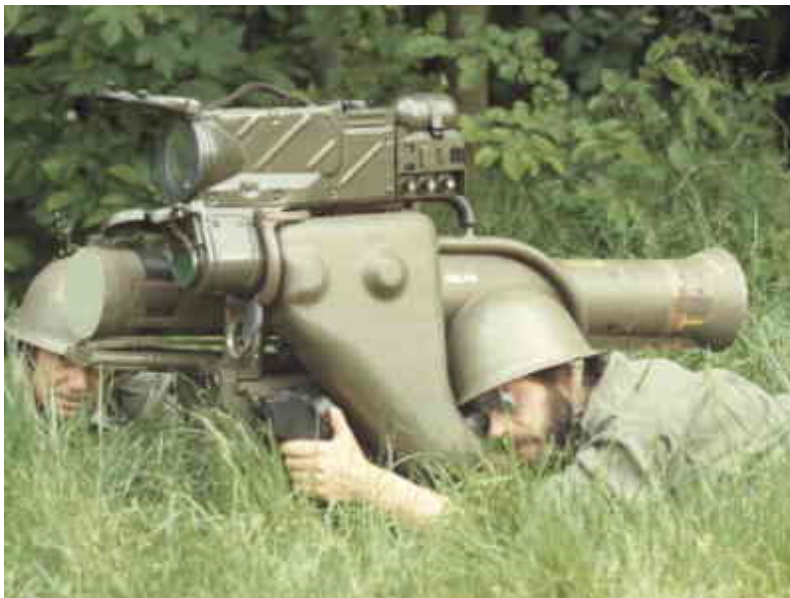
Abb. 6: MILAN System mit oben aufgesetztem, kompressor-gekühltem MIRA Infrarot Visier
