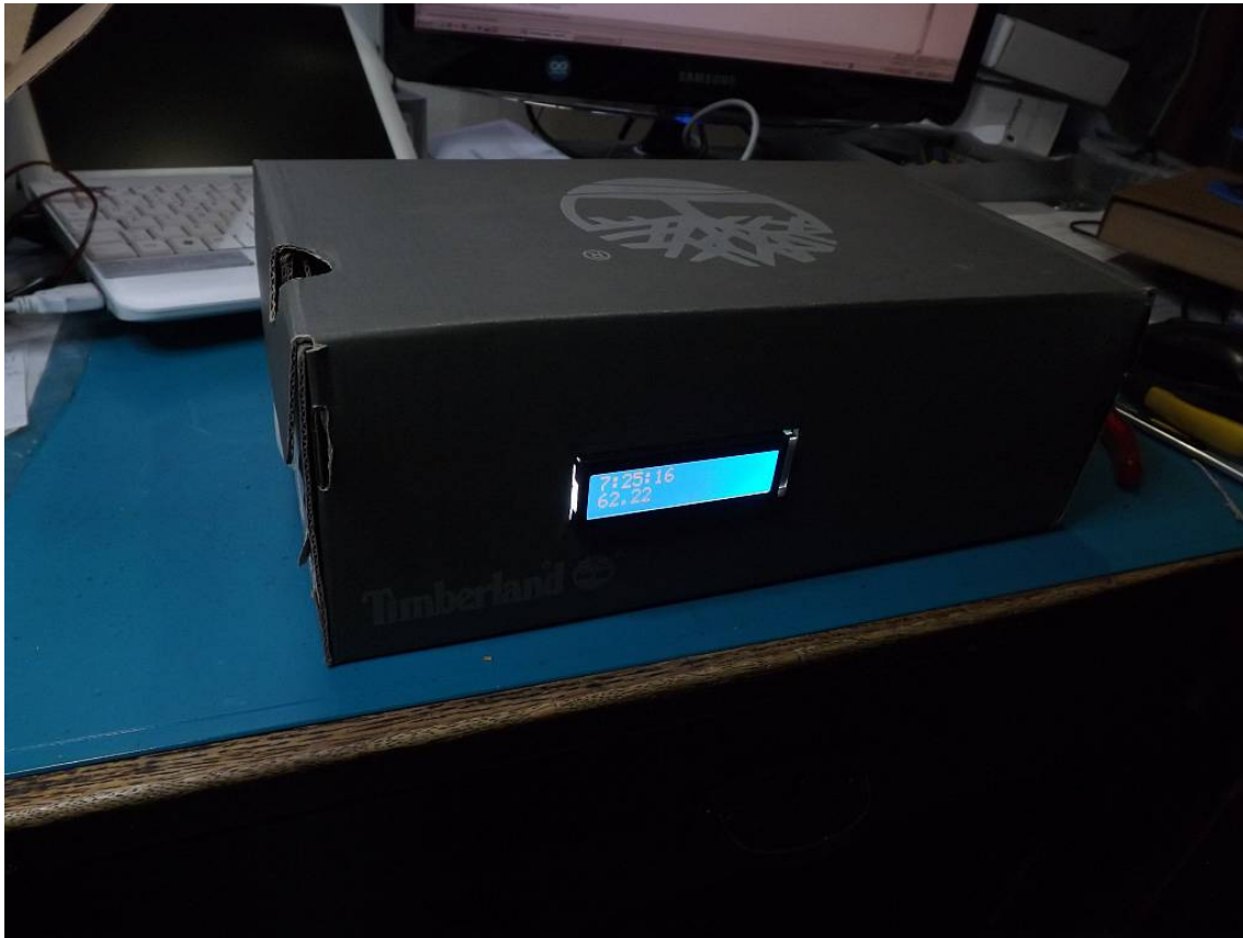
Abb. 5: Das beleuchtete LCD-Display wird an der Seitenwand montiert und kommt später in der Umhängetasche oben zu liegen.
