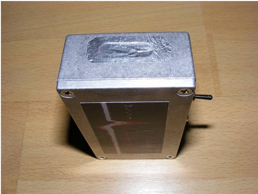
Abb. 12: Mit selbstklebender Alufolie verschlossene Blendenöffnung
