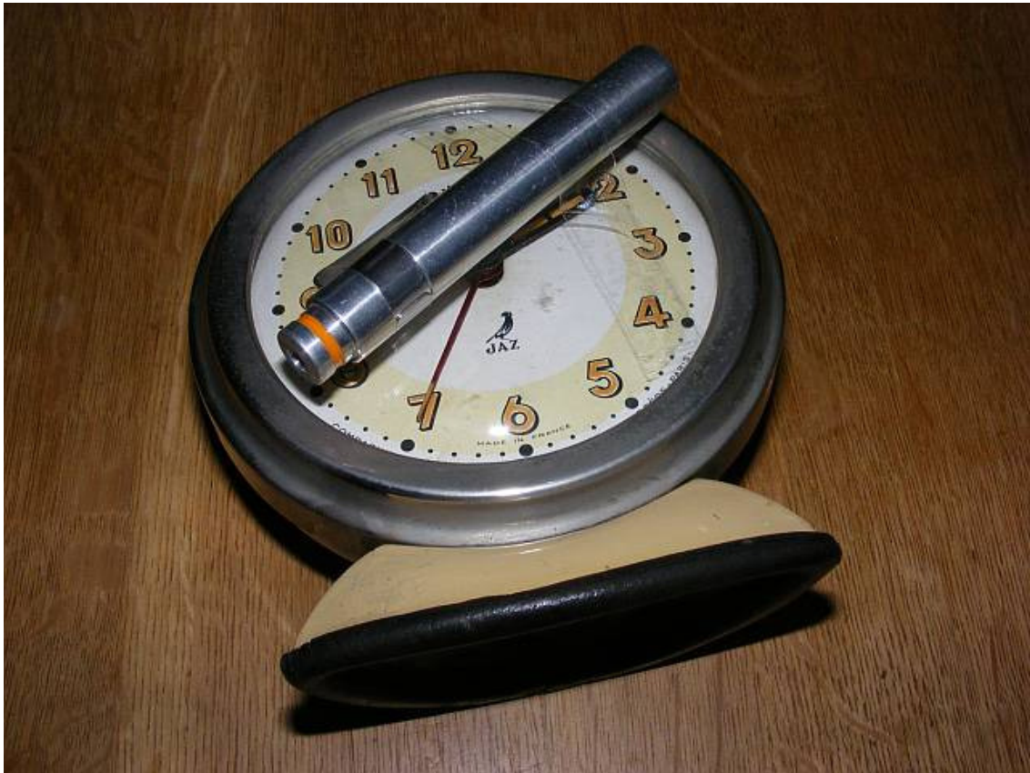
Abb. 3: Der Versuch einer Entladung durch Gammastrahlung
