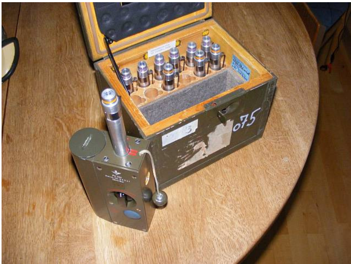
Abb. 2: Ladevorgang eines 50Roentgen Stabdosimeters
