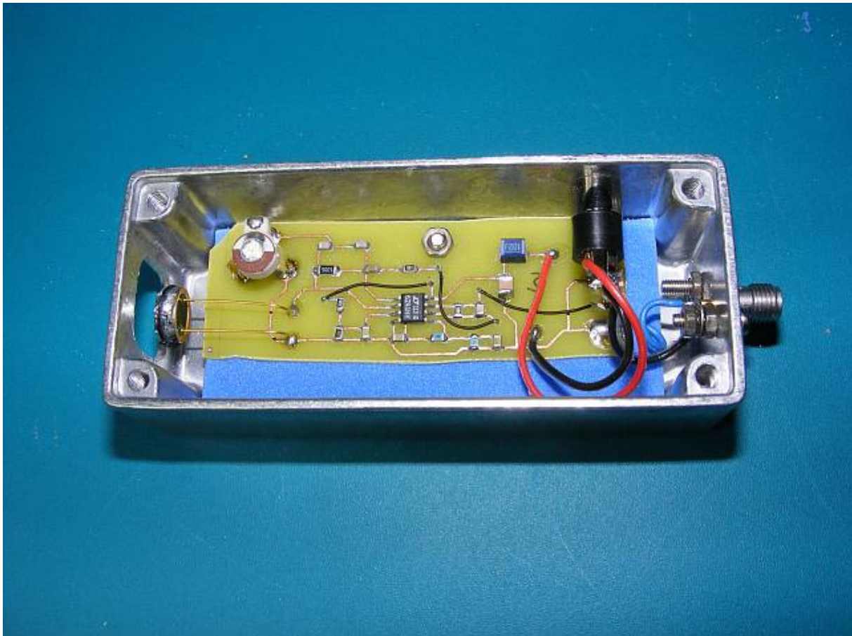
Abb. 2: Das „Mini-Geigerle“ mit Alpha-empfindlichem Detektor in geöffnetem Gehäuse
