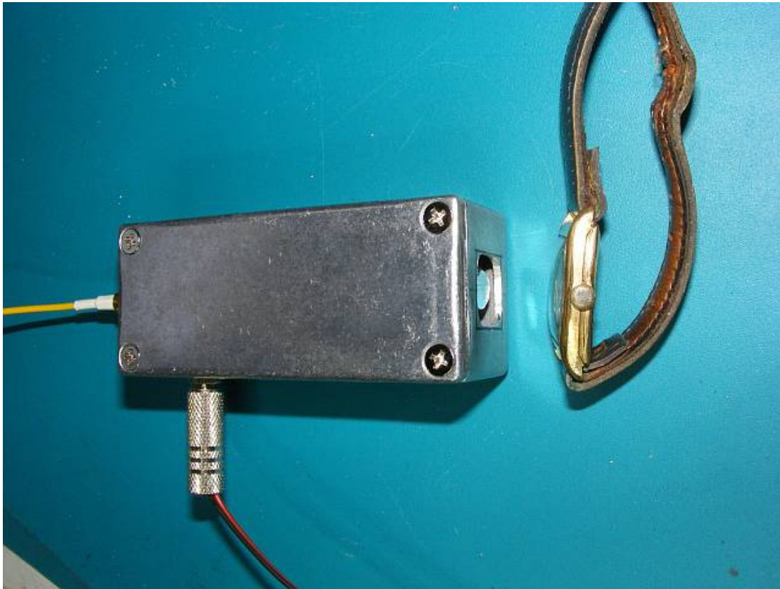
Abb. 1: Das „Mini-Geigerle“, der Messverstärker direkt an der PC-Soundkarte angeschlossen, externe 12V Stromversorgung
