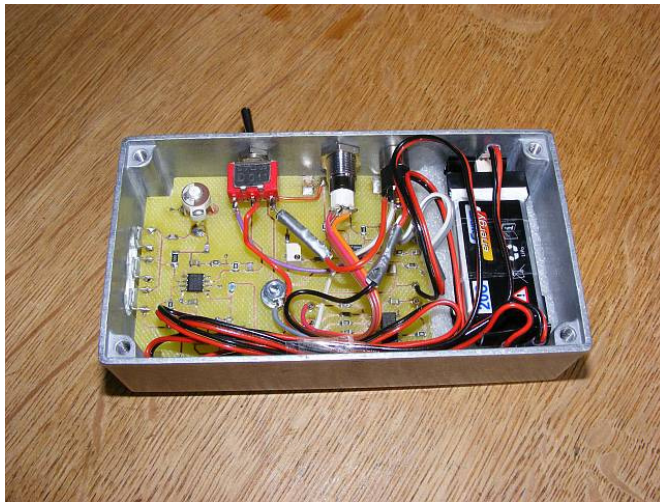
Abb. 4: Solar-Ladeanschluss über Ohrhörerbuchse und 3 Lipo-Zellen eingebaut
