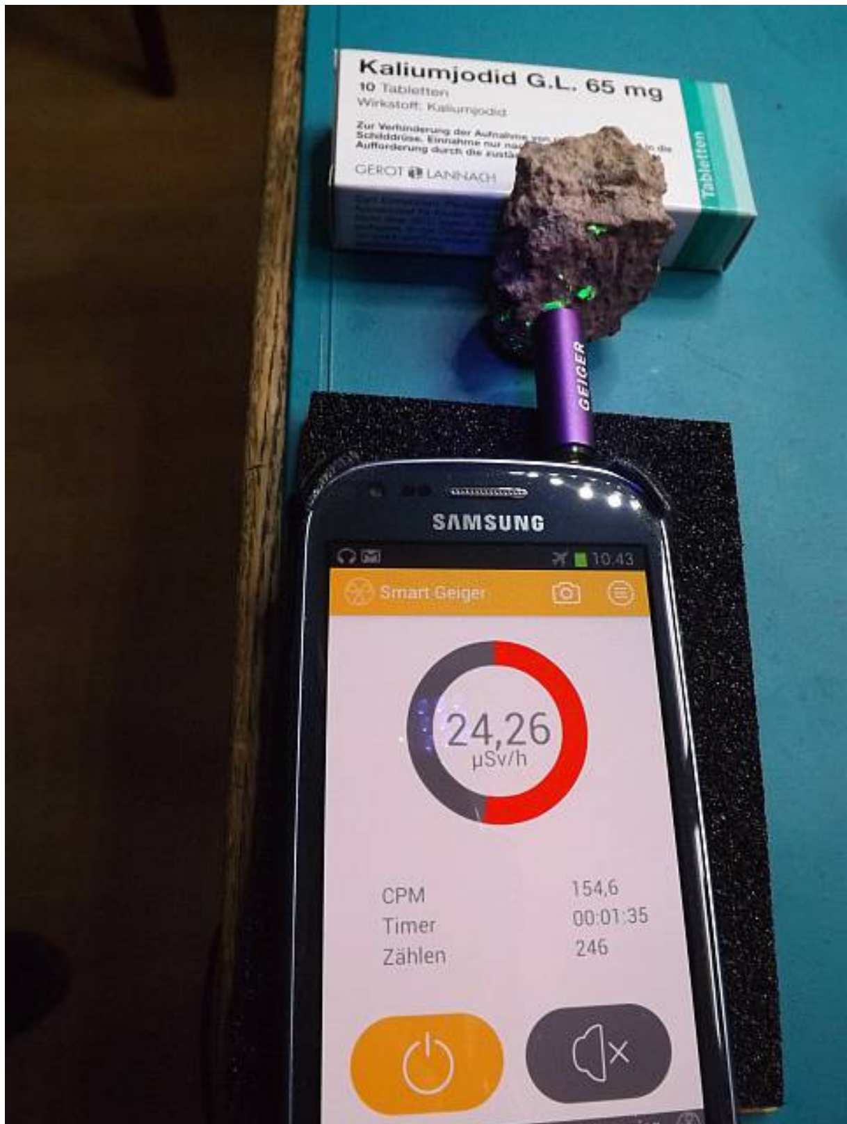
Abb. 8: Für Mineraliensucher sehr zu empfehlen, der Geiger Stick von FT Labs: Uranglimmer auf Bärhalde-Granit (Menzenschwand). Man beachte die extreme Strahlungsgeometrie, der Sensor ist trotz der kleinen Größe des Uranocircit-Kristalls voll ausgeleuchtet (Hintergrundbeleuchtung mit UV-Licht)
