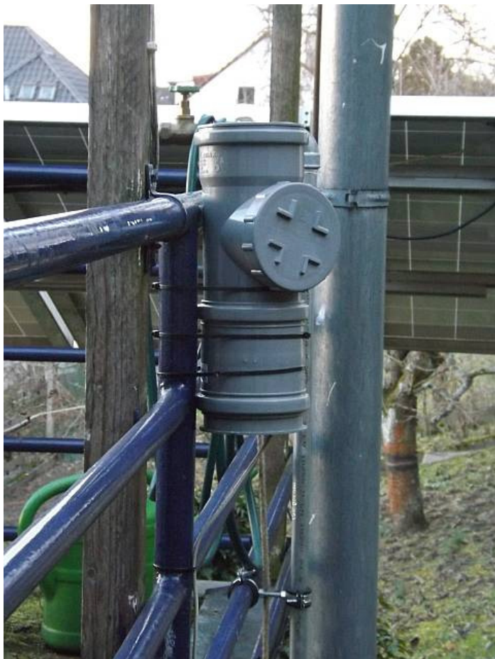
Abb. 1: Eine bisherige low-cost Messstation für Umweltradioaktivität in Besigheim
