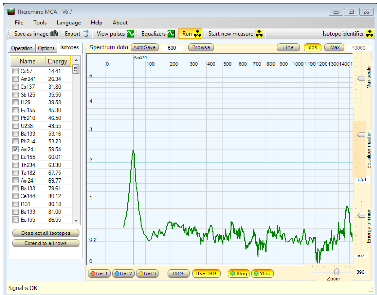
Abb. 3: Das Gammaspektrum des Rauchmelders: relativ eindeutig, klar und deutlich sieht man die 59keV Linie des Americiums selbst durch das Gehäuse
