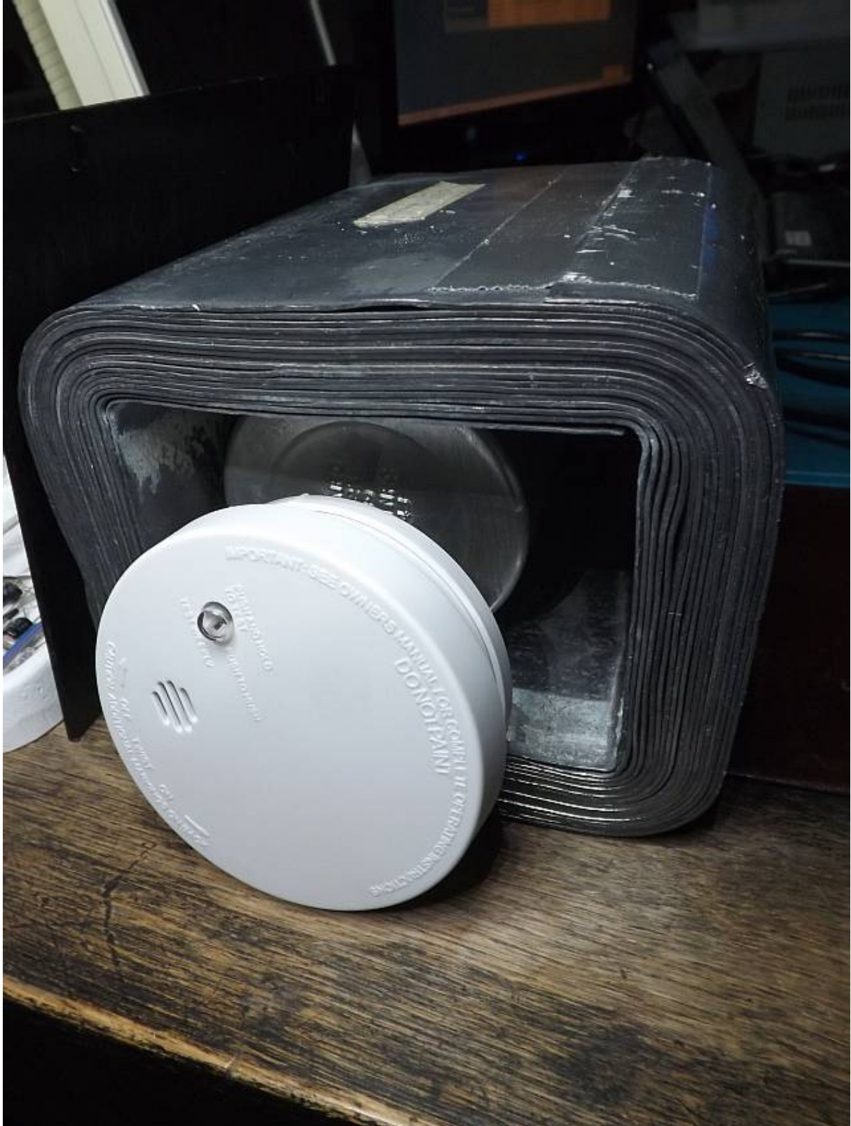
Abb. 2: Ein Ionisationsrauchmelder in seinem Gehäuse vor dem Szintillationsdetektor eines Gamma-Spektroskops
