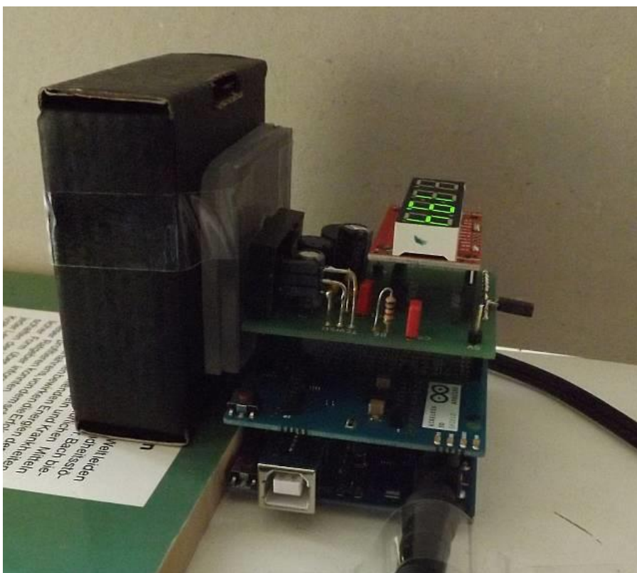
Abb. 7a, b: Messung mit dem Tino Messgerät und Aufzeichnung der Messdaten auf SD-Karte (der Kartenslot für die Micro-SD-Karte befindet sich auf der anderen Seite der mittleren Platine).
