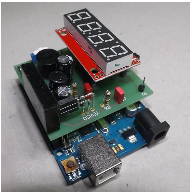
Abb. 6: Das selbstgebaute Tino Messgerät mit Teviso Radioaktivitäts-Sensor und Arduino Mikrocontroller
