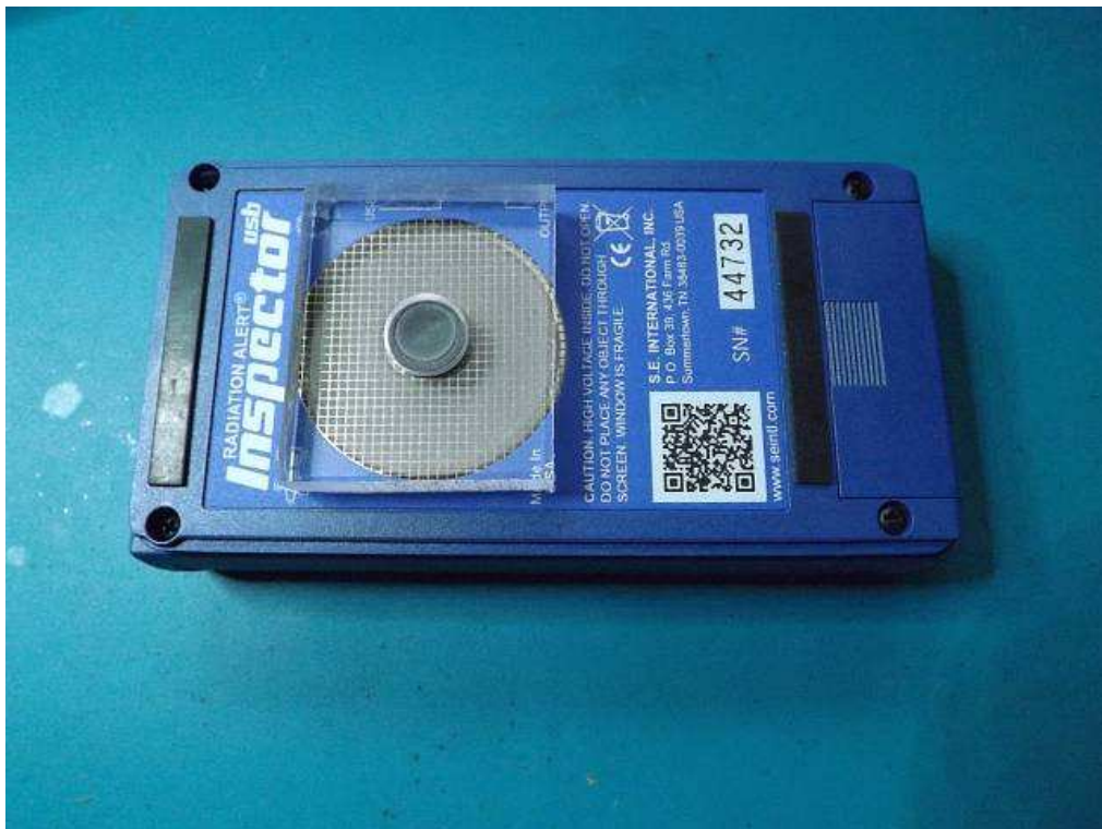
Abb. 5: Messung der Aktivität der Kohletablette durch die Folie auf dem Inspector
