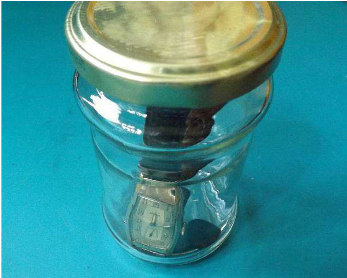
Abb. 10: Eine alte Junghans Armbanduhr mit Radium-Leuchtfarbe im Probenglas zusammen mit einer Kohlekomprette welche das Radon adsorbiert
