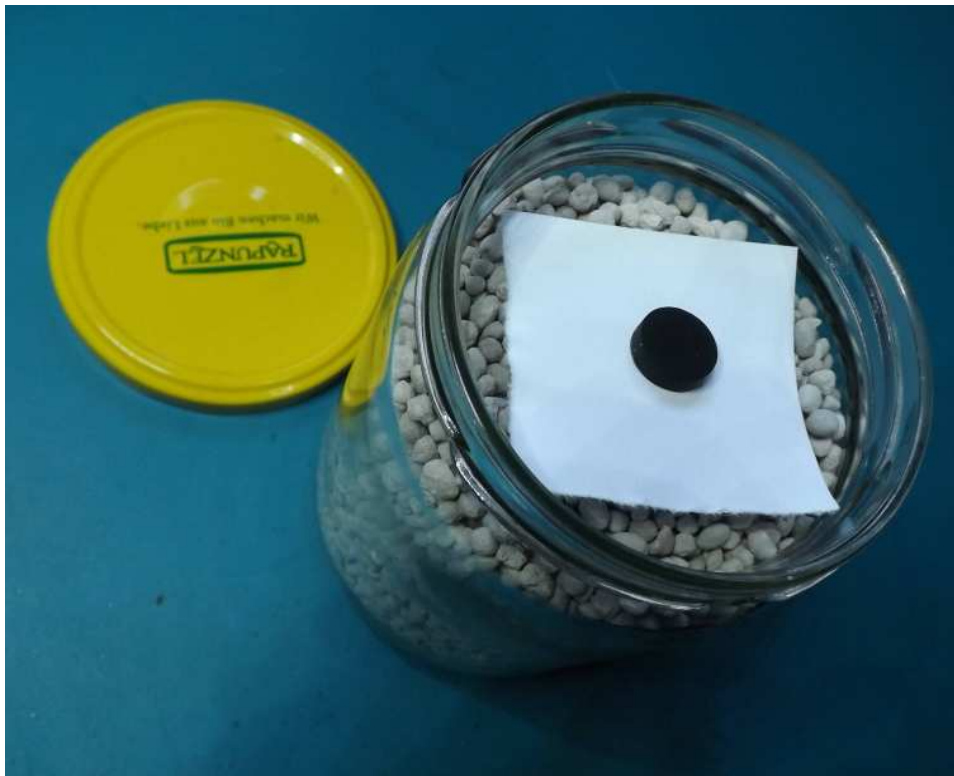
Abb. 3: Ein mit 500ml Superphosphat Düngemittel gefülltes Glas mit Kohletablette
