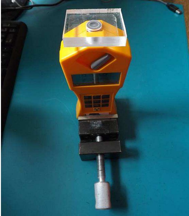
Abb. 7: Messung mit dem Gammascout, der Tablettenhalter befindet sich genau über dem Zählrohrfenster bei geöffneter Blende
