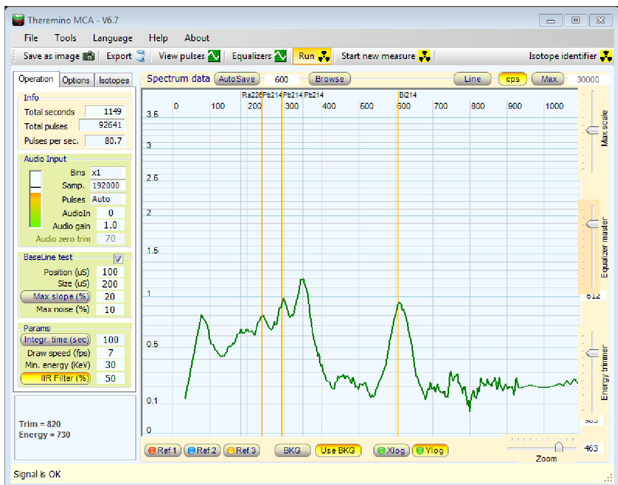
Abb. 2: Gamma-Spektroskopie von uranhaltiges Superphosphat Düngemittel des Herstellers ICL in Ludwigshafen am Rhein (Rohphosphat aus der Negev-Wüste in Israel)
