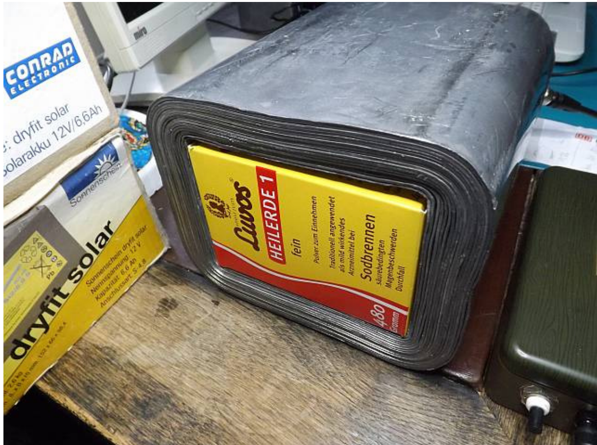
Abb. 5: Eine Packung Heilerde in der Bleikammer eines selbstgebauten Gamma-Spektroskopiegeräts, für Gamma-Strahlung ist die Papp-Verpackung völlig transparent
