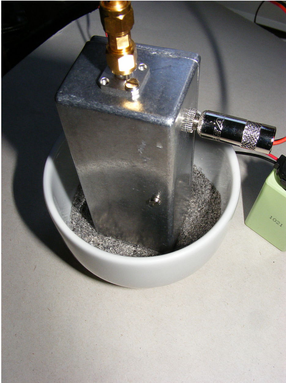
Bild 1: Messaufbau für die Messung der Radioaktivität an Zigarettenasche
