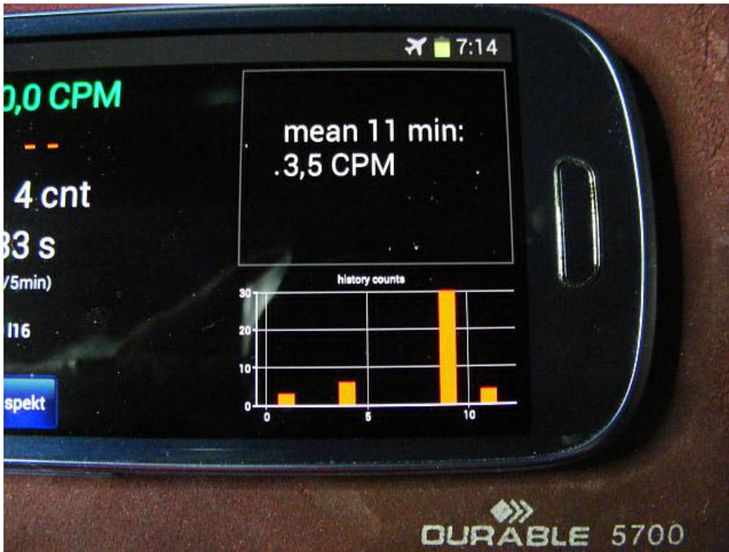
Abb. 6: Zeitdiagramm (History) des Grundrauschens bei Noise=10
