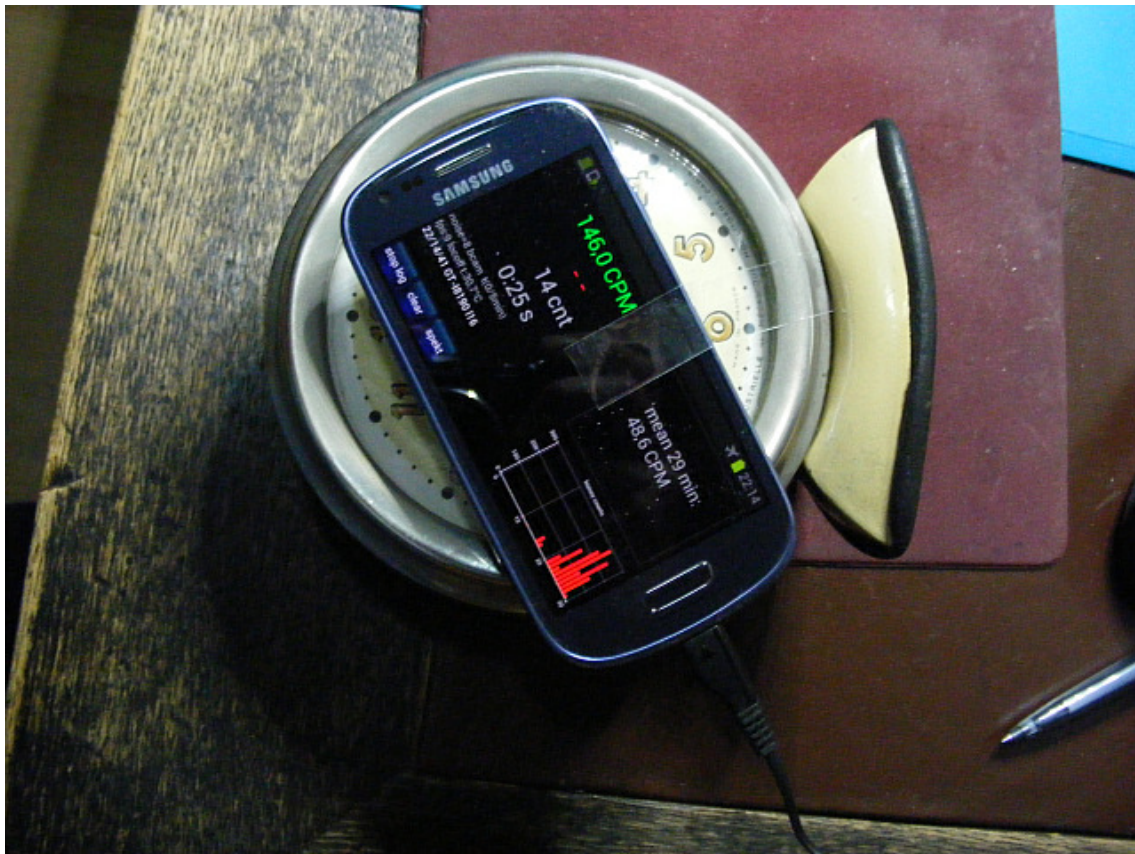
Abb. 2: Messung mit der Grobeinstellung von Noise=8 auf einem Wecker mit Radiumhaltigen Leuchtziffern
