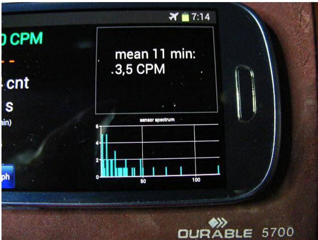
Abb. 5: Spektrum des Grundrauschens bei Noise=10
