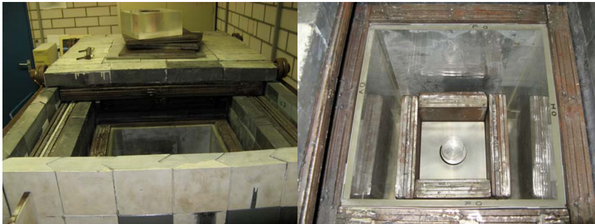
Abb. IV.1 Abdeckungen und Inneres des Gammaskpektrometers
