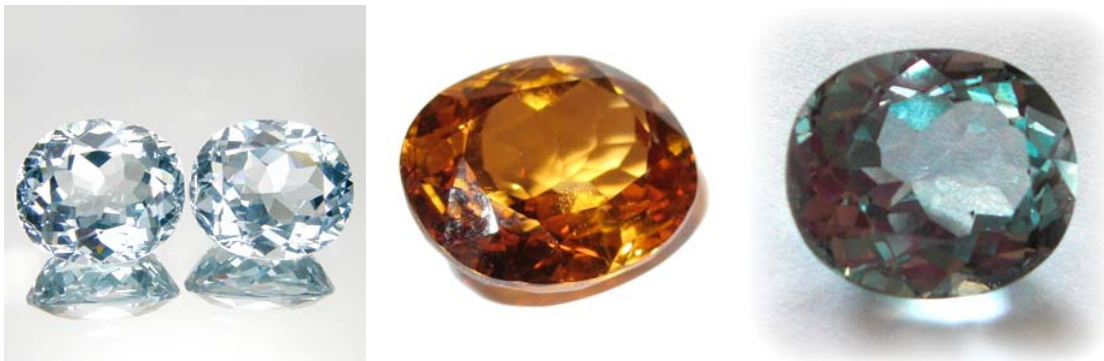
Abb. IV.3 Topas 9b) vor und nach der Bestrahlung sowie nach dem Erhitzen
