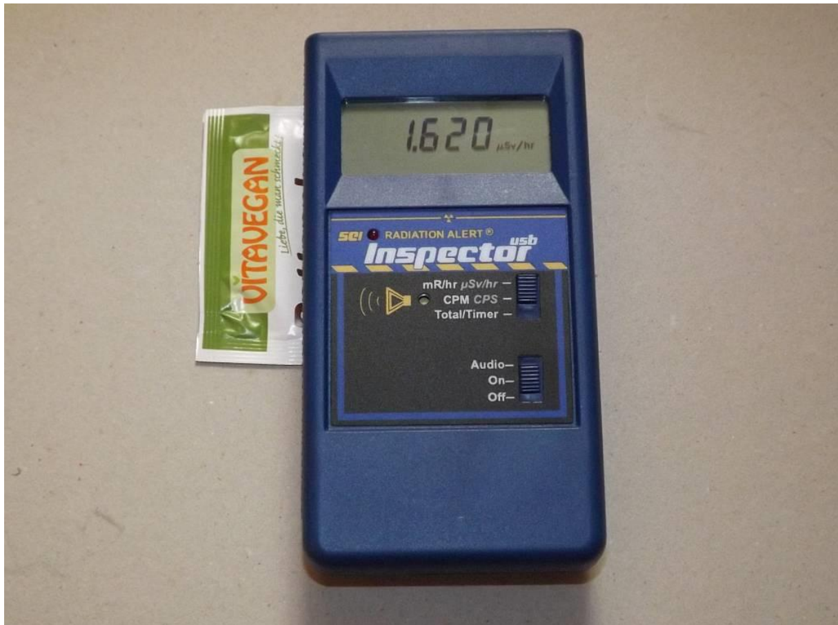
Abb.2: Messung der Radioaktivität (zusammen mit dem Hintergrund), Fenster des Geigerzählers befindet sich auf der Unterseite, das Gerät zeigt hohe Werte (relativ für Lebensmittel) an
