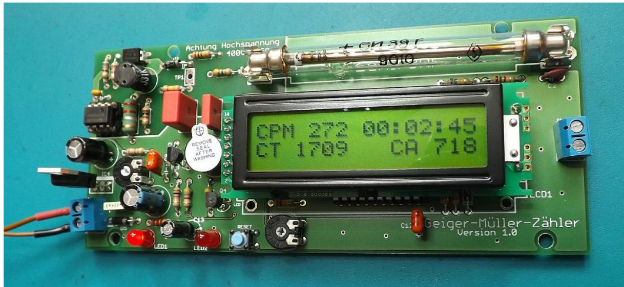
Abb. 3: Nach ein paar Stunden Löten hat man das Gerät aufgebaut. Den lästigen Summer klebt man aber am besten gleich wieder mit der Schutzfolie zu. Rechts die Anschlussklemme für die Zählimpulssignale (Ausgang eines HEF40106 CMOS Schmitt-Trigger Gatters).
