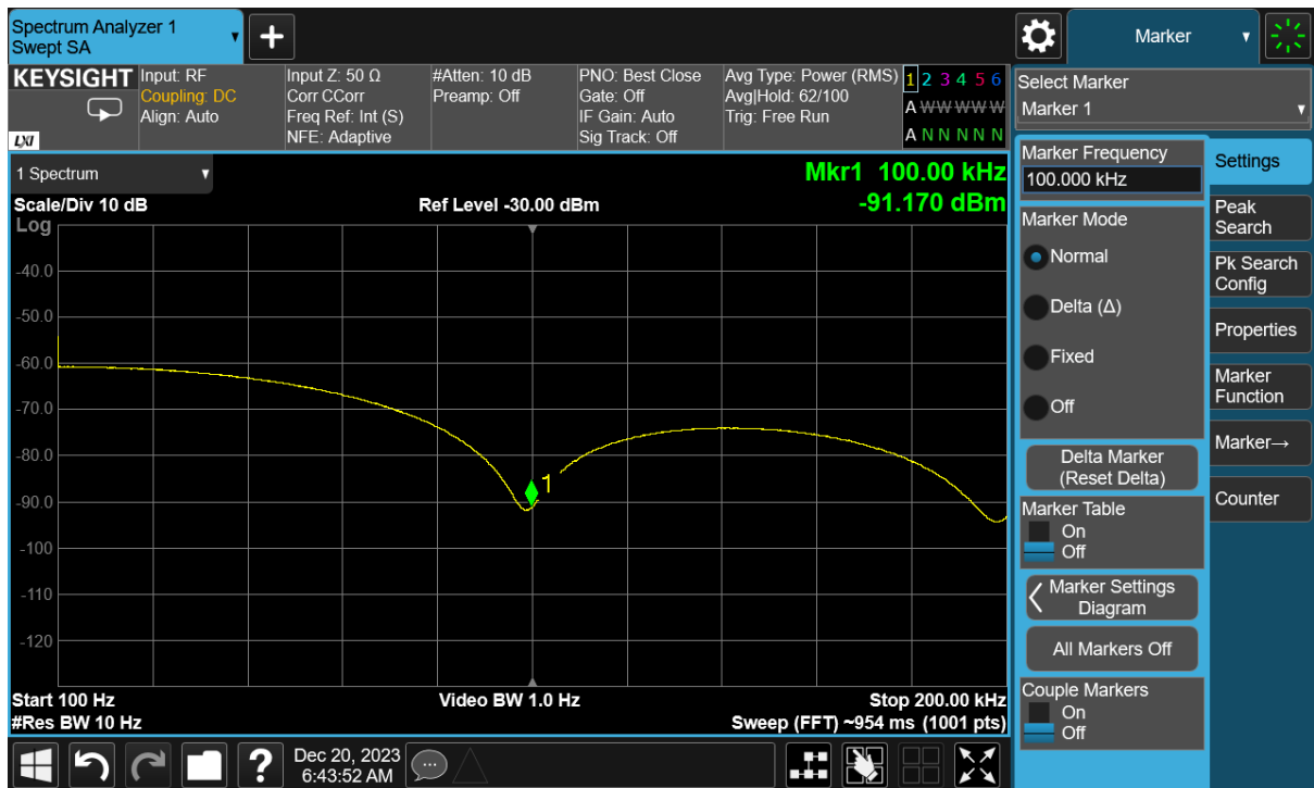
Abb. 6: Fourier-Spektrum (in dB) des zufälligen Zählimpuls-Signals mit einer Impulsdauer von 10 \mu s
