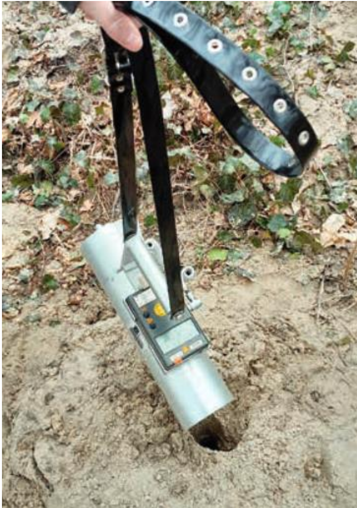
Abb. 13: Die Abbildung 4.13 aus dem Jahresbericht LLBB zeigt eine professionelle Sonde für Ortsdosisleistungsmessungen vom Typ Automess 6150AD-b/E mit dem Handgerät 6150AD6/E über einem Bohrloch
