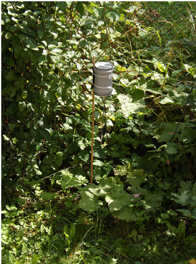
Abb. 8: Tino-Shield basierte Messstation (Teviso-Sensormodul und Arduino in einer Messdose, aus einem Drainagerohrstück mit Blindstopfen hergestellt)
