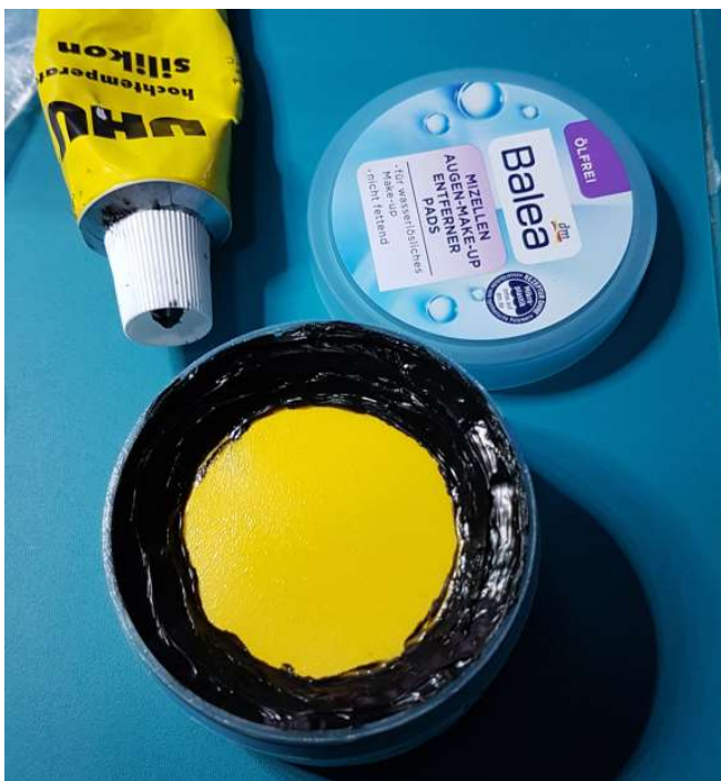
Abb. 2c: Herstellung der Mischprobe, luftdichter Verschluss der Folienabdeckung mit einer Silikonfuge zur Dosenwand hin
