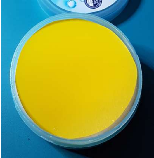
Abb. 2b: Herstellung der Mischprobe, Abdeckung der Mischung mit einer dünnen Kreisscheibe aus Kunststoffolie
