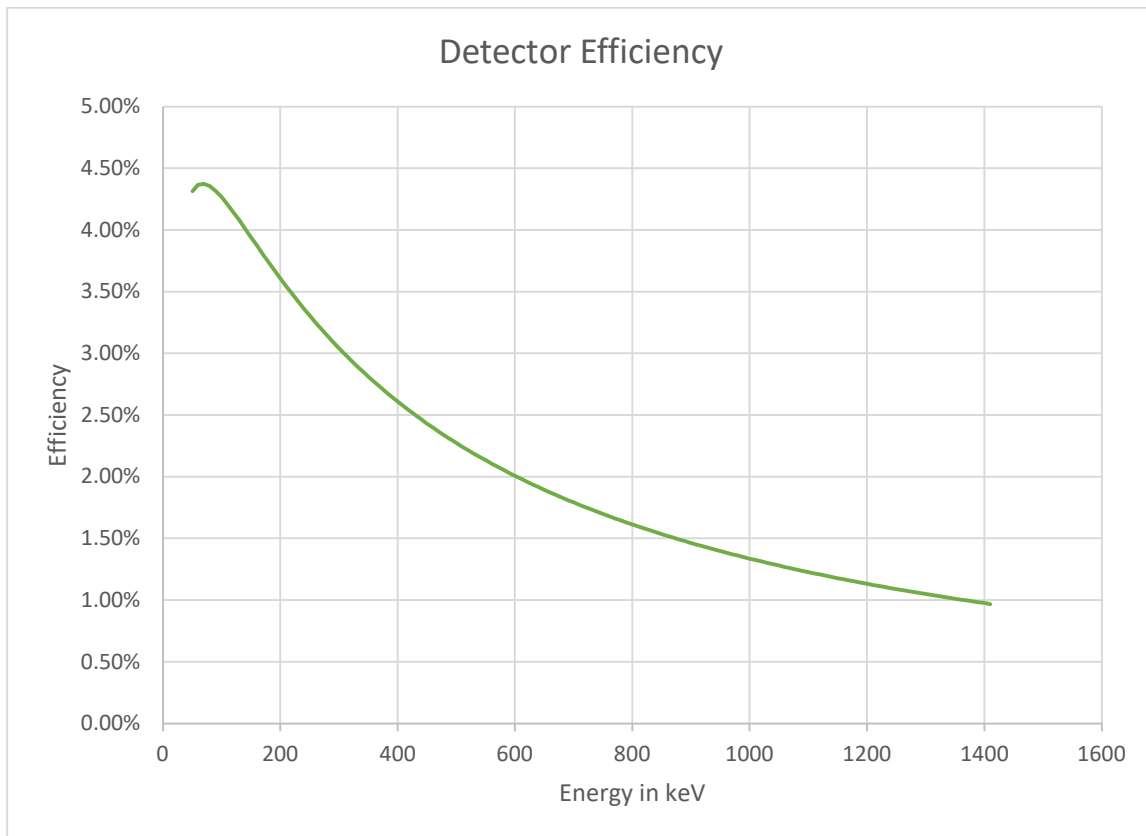
Abb. 4: Mit der Kalibrierung gewonnene Detektor Effizienz Funktion eines 2.5“ NaI Detektors
