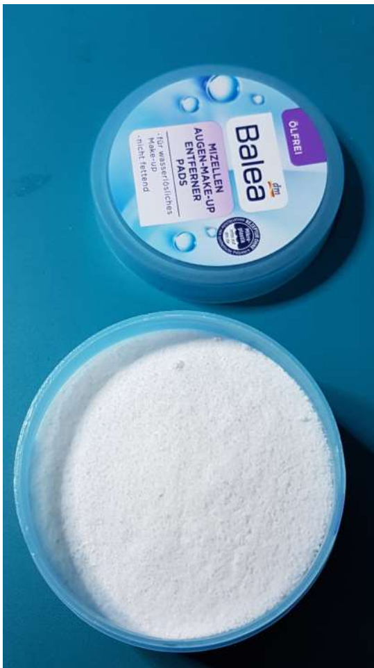
Abb. 2a: Herstellung der Mischprobe, Mischung aus 100g KCl und 10g \text{Lu}_2\text{O}_3 im Balea Probengefäß
