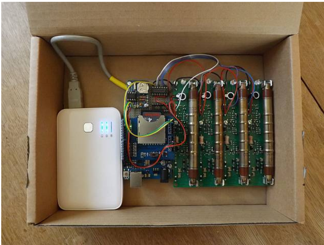
Abb. 2: Der Kontaminationszähler untergebracht in einer einfachen Pappkiste als Prototyp
