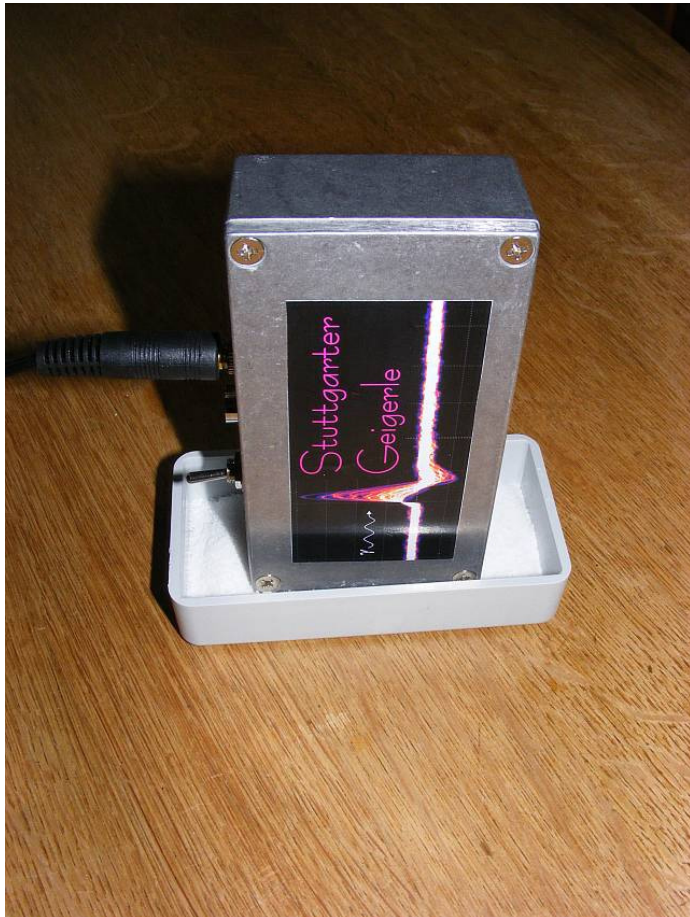
Abb. 3: Kalibriermessung mit Kaliumchlorid für das Stuttgarter Geigerle
