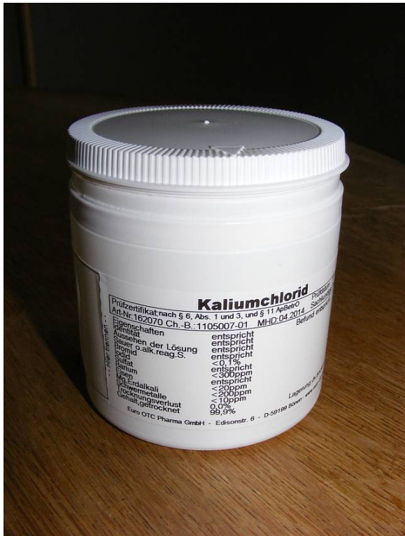
Abb. 2: Reinstes Kaliumchlorid als Prüfstrahler aus der Apotheke (3.50 Eur)
