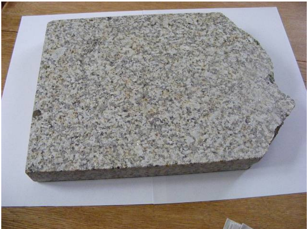
Bild 1: Normale Granitplatte, die als Baumaterial (Bodenbelag) verwendet wird
