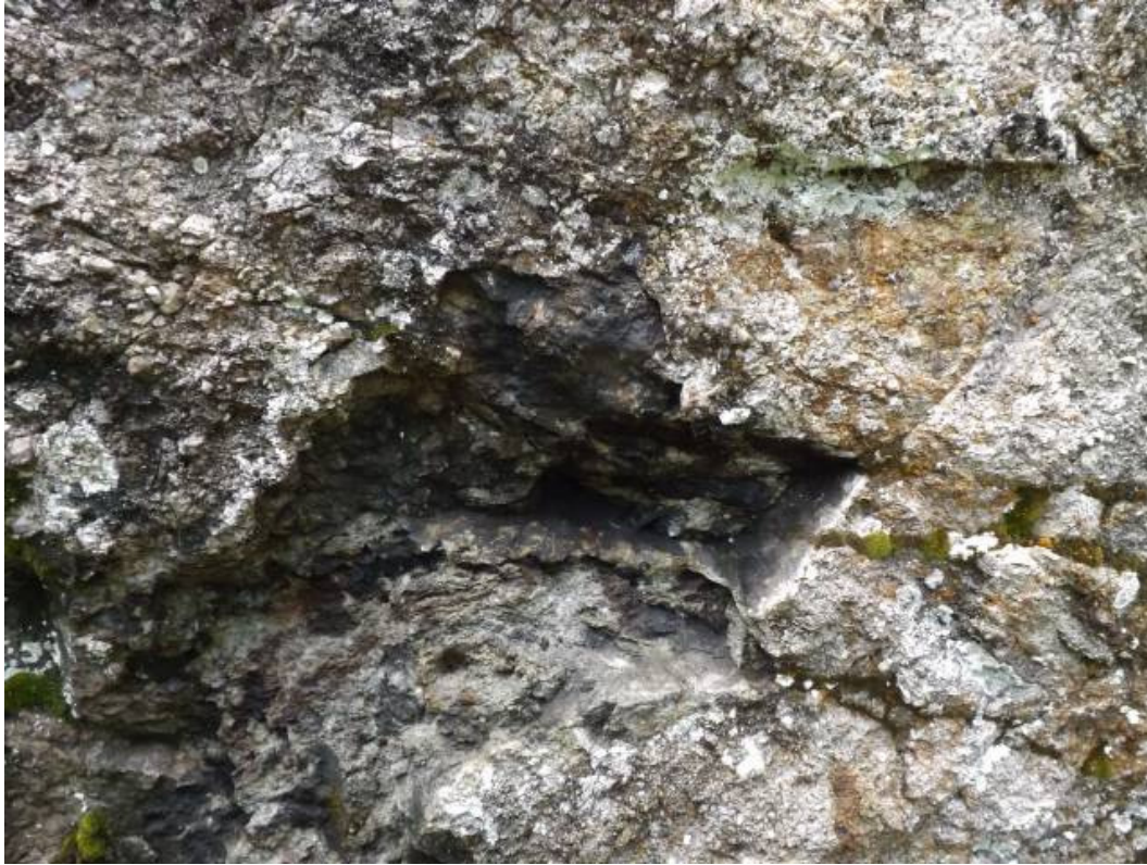
Abb. 10: Die heiße Zone im Bereich einer Violettverfärbung
