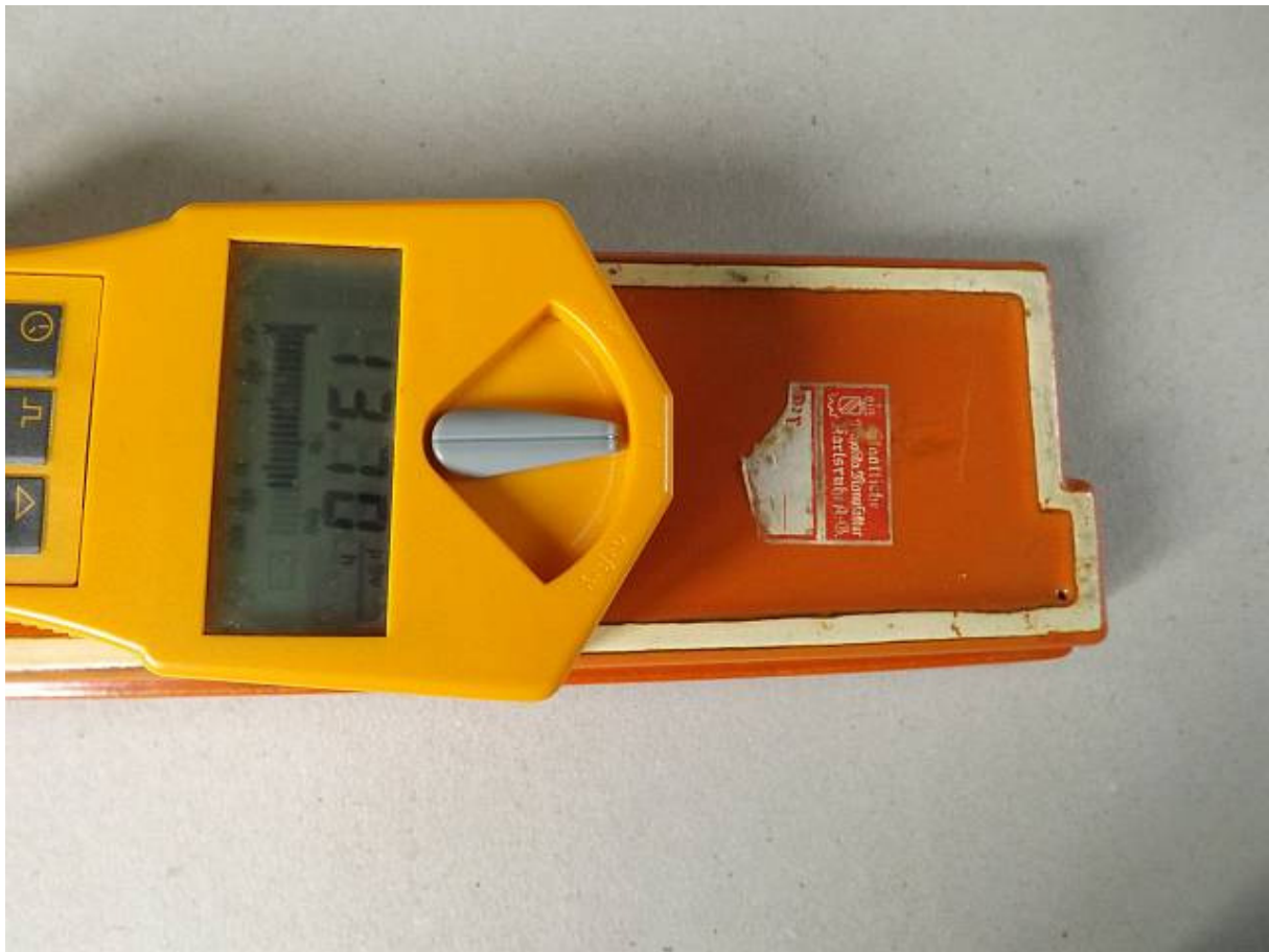
Abb. 3: Messung der Dosisleistung auf der Rückseite, deutlich ist das Etikett mit dem badischen Logo zu erkennen
