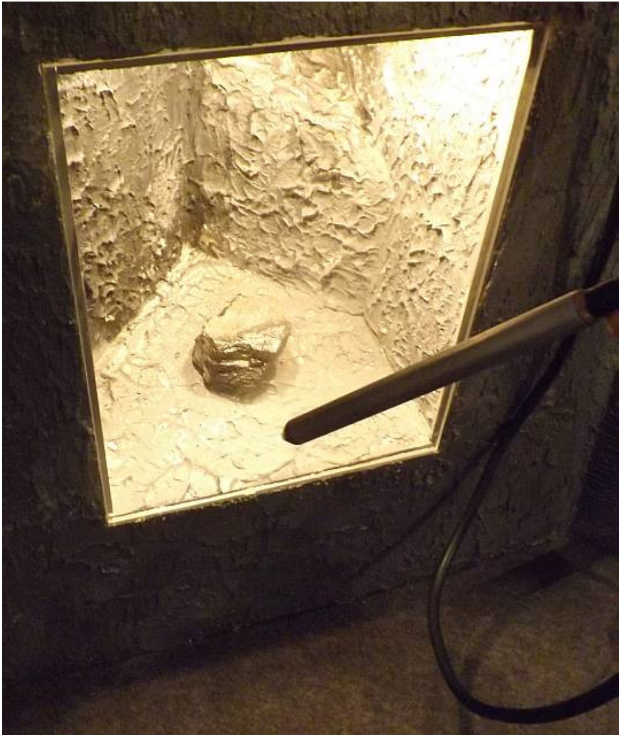
Abb. 8: Das Highlight der Ausstellung: Eine Installation zur radiometrischen Prüfung eines großen Brockens Pechblende mit einem Wismut Geigerzähler mit Sonde, die man selbst führen kann. Abschirmung der Betastrahlung mit Plexiglas.
