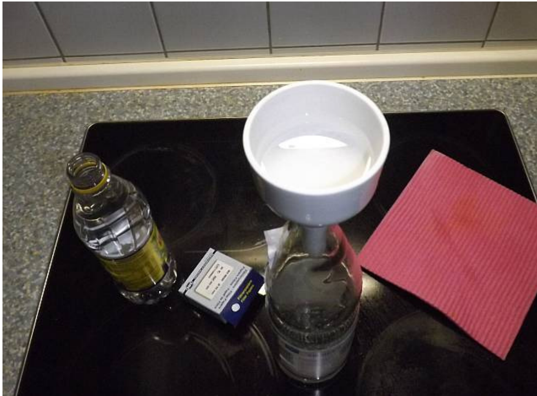
Abb. 28: Filtrieren des Radon-Heilwassers durch ein Glasfaserfilter in einem Büchnerfilter.
