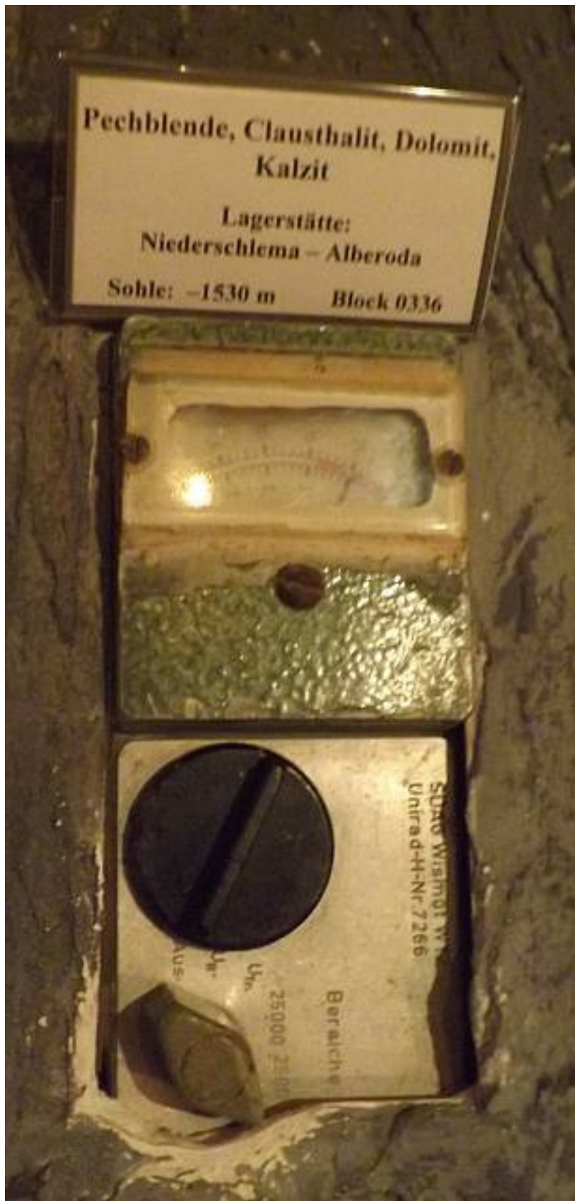
Abb. 9: Wenn man die Sonde richtig vor die Pechblende hält geht die Anzeige völlig in den roten Bereich des historischen Zählers vom Typ „Unirad“
