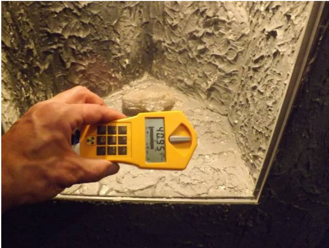
Abb. 10: Vergleichsmessung mit dem Gammascout: Die Pechblende erzeugt stolze Dosisleistungswerte
