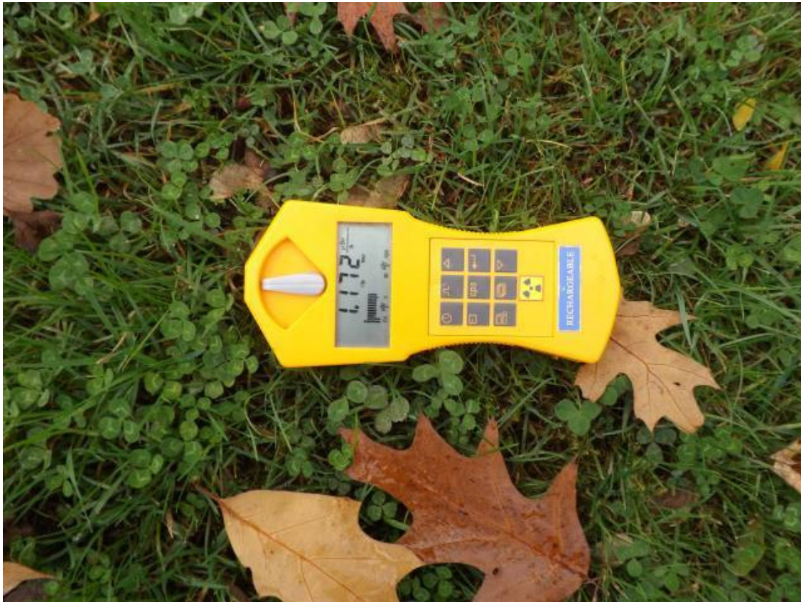
Abb. 4: Messung mit dem Gammascout auf dem Boden im Bereich der höchsten Strahlung
