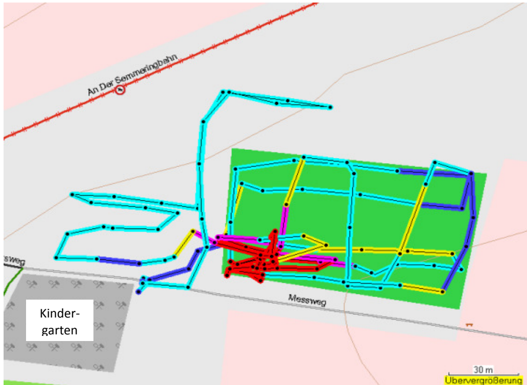
Abb. 1: Geo-referenzierte Messung der Gamma-Dosisleistung (rot >0.5\mu\text{Sv/h} , magenta >0.4\mu\text{Sv/h} , gelb >0.3\mu\text{Sv/h} , türkis >0.2\mu\text{Sv/h} , blau >0.1\mu\text{Sv/h} )
