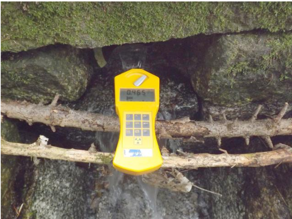
Abb. 3: Ein Geigerzähler der Marke Gammascout mit geöffnetem Alphafenster vor dem Auslass des Quellbrunnens
