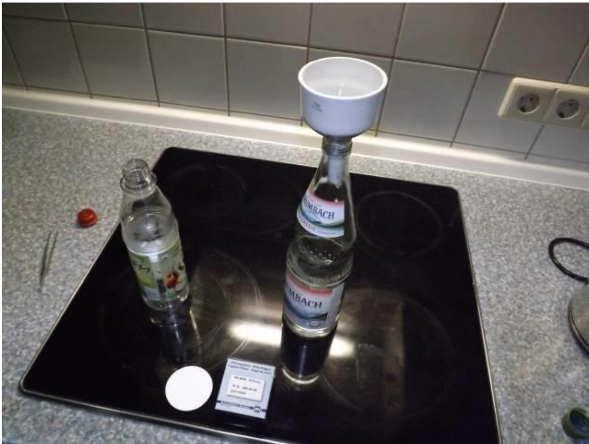
Abb. 5: Filtern des Quellwassers durch eine Glasfaser-Filterzscheibe mit Hilfe eines Buchner-Filters
