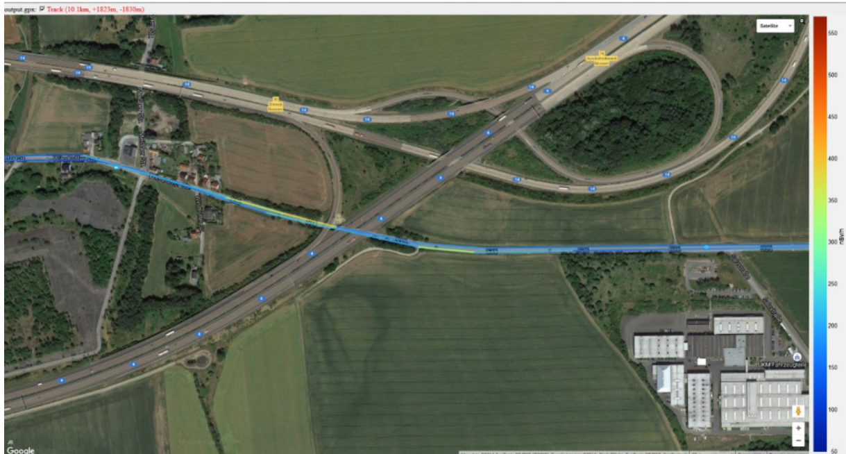
Abb. 9: Dosisleistung aus dem Fahrzeug gemessen bei der Durchfahrt unter der Brücke auf der Wilsdruffer Straße bei Obereula
