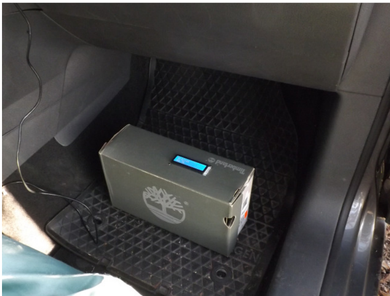
Abb. 1: Szintillationszähler mit Daten-Logger und Real-Time-Clock im Schuhkarton im Fußraum des Fahrzeugs
