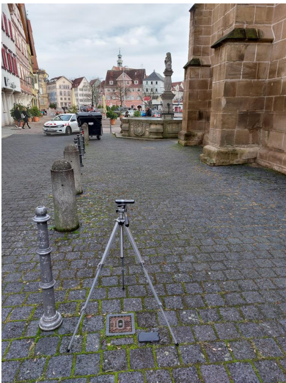
Abb. 3b, c: Messung der Gamma-ODL mit dem Radiacode RC101: 0.462uSv/h
