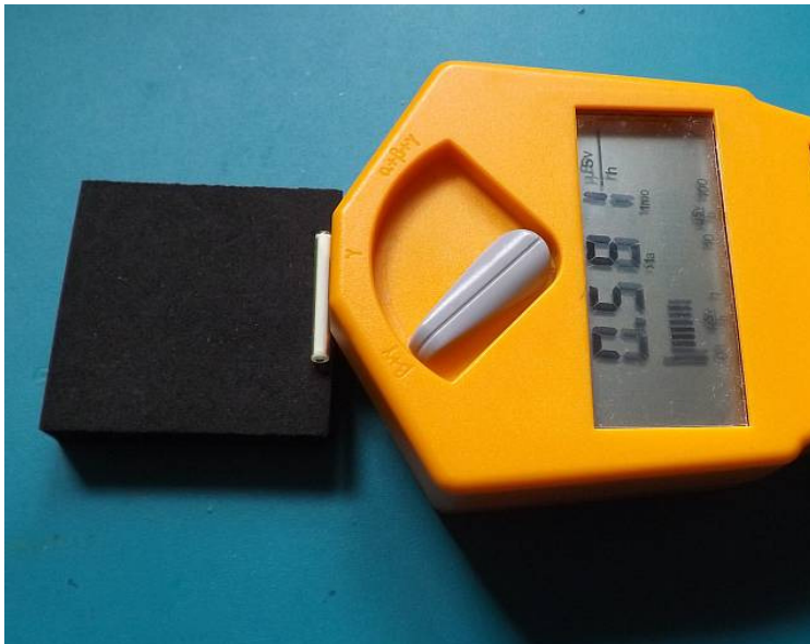
Abb. 4b: Tritiumgaslichtquelle gedämpft mit 0.1mm Alufolien-Blende
