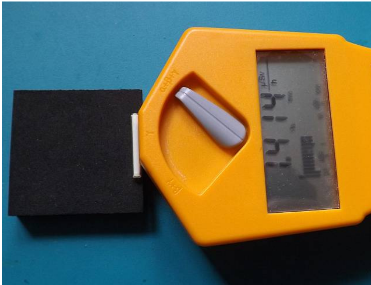
Abb. 4a: Tritiumgaslichtquelle vor dem ungedämpften Endfenster des Zählrohrs
