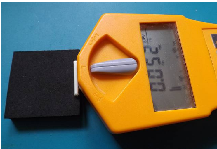
Abb. 4c: Tritiumgaslichtquelle gedämpft mit 3mm Alublende
