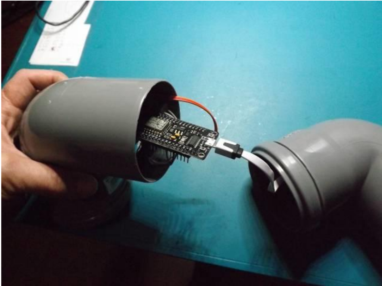
Abb. 3: Das Sensor-System im U-Rohr versenkt mit USB-Stromanschlußkabel
