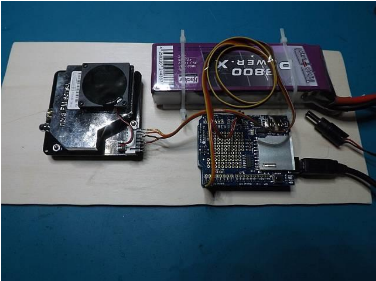
Abb. 2: Arduino-basierter Datenlogger mit Real-Time Clock zur Aufzeichnung von Feinstaub-Messdaten auf SD-Karte
