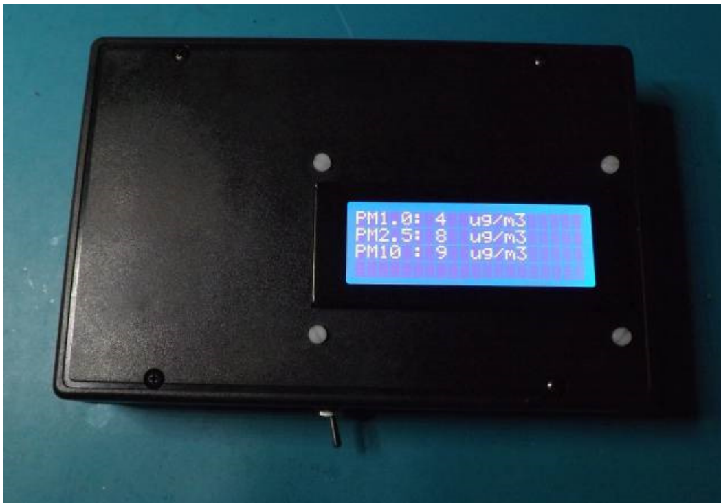
Abb. 3: Das Feinstaub-Messgerät in Betrieb, eingebaut im Gehäuse
