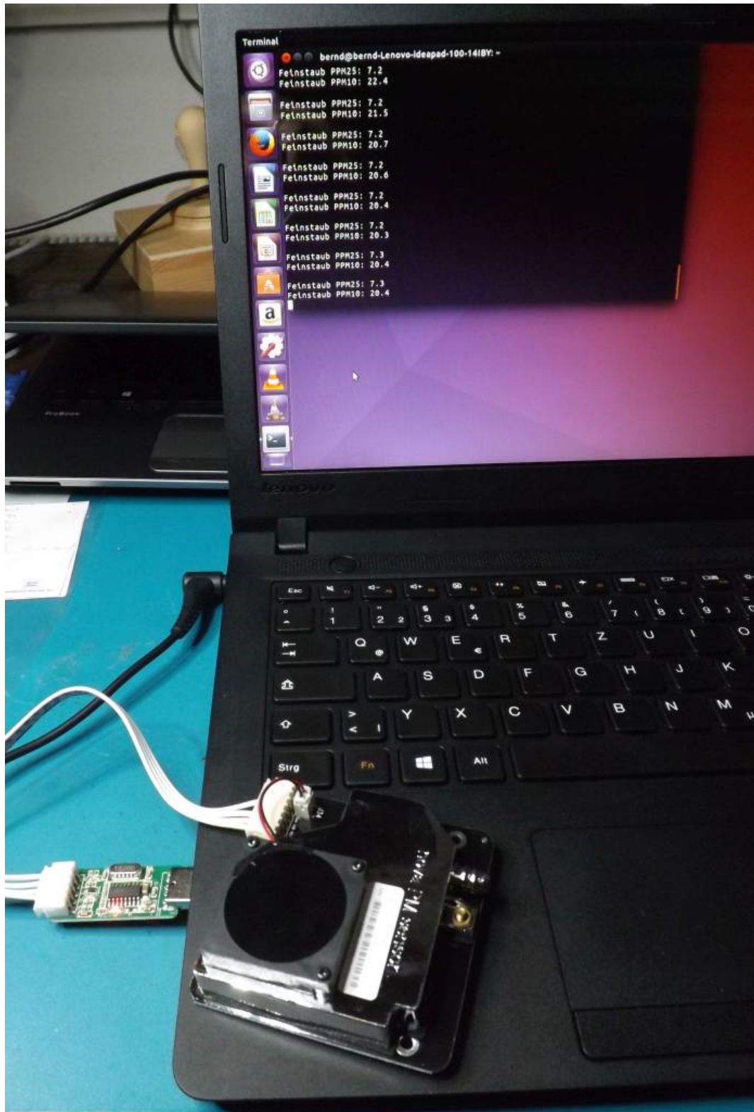
Abb. 1: Auslesen des Feinstaubsensors mit USB2TTL Konverter unter Linux (Ubuntu)
