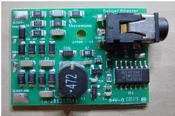
Abb. 3: Theremino Zählrohr-Treibermodul GA-500
