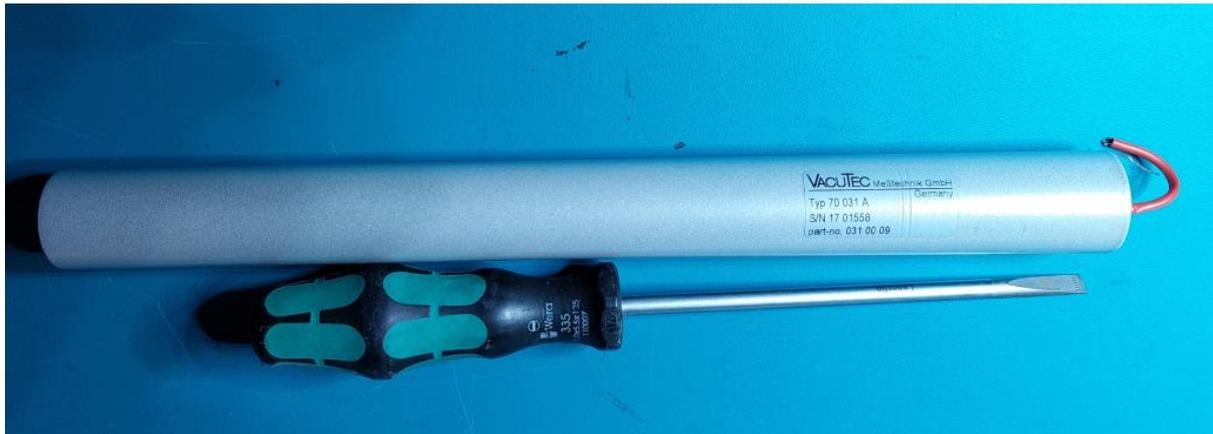
Abb. 1: Das energiekompensierte VacuTec Zählrohr 70031A im Größenvergleich zu einem normalen Schraubenzieher
