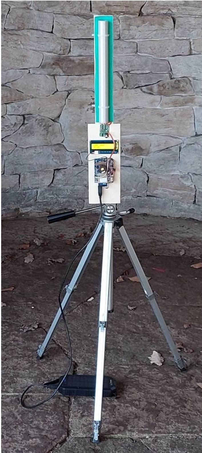
Abb. 8: Befestigung der Grundplatte der OM01-Sonde auf Gonadenhöhe an einem Fotostativ
