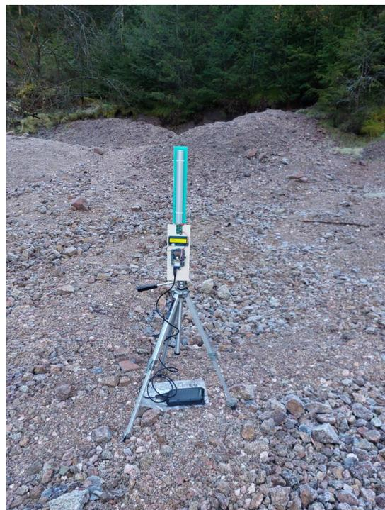
Abb. 9a, b: Einsatz der OM01-Sonde in Wittichen, Schwarzwald a) auf einem Waldweg, der über die ehemalige Halde der Grube Sophia führt (Zählrate 747cpm) und b) Messung mit der OM01 Sonde auf der Schmiedestollenhalde (Zählrate 1344cpm)
