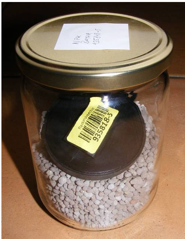
Abb. 1: Messgefäß mit Düngemittelgranulat und Radondetektor (Kernspurdosimeter)
