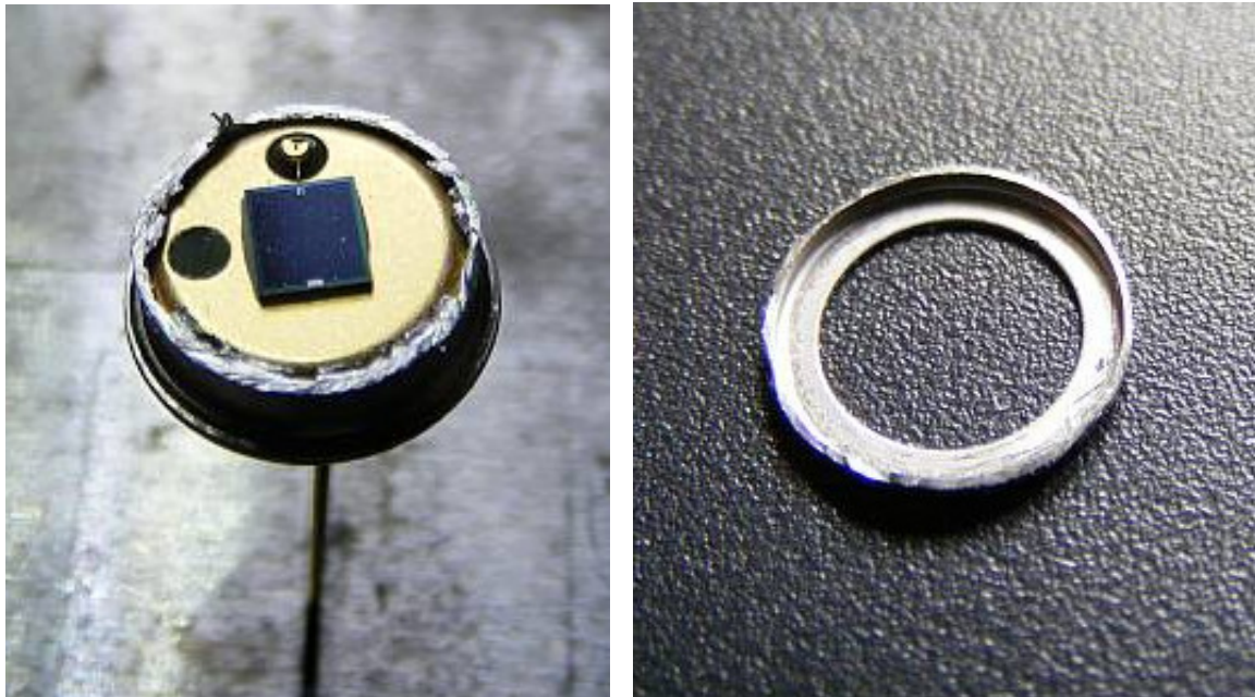
Abb 2a, b: Aufgetrenntes Gehäuse einer S1223 PIN Photodiode und das abgetrennte Oberteil
